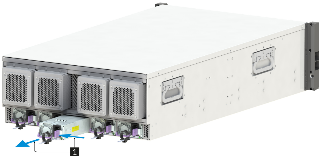
Рис. 51. Извлечение блока питания сервера
