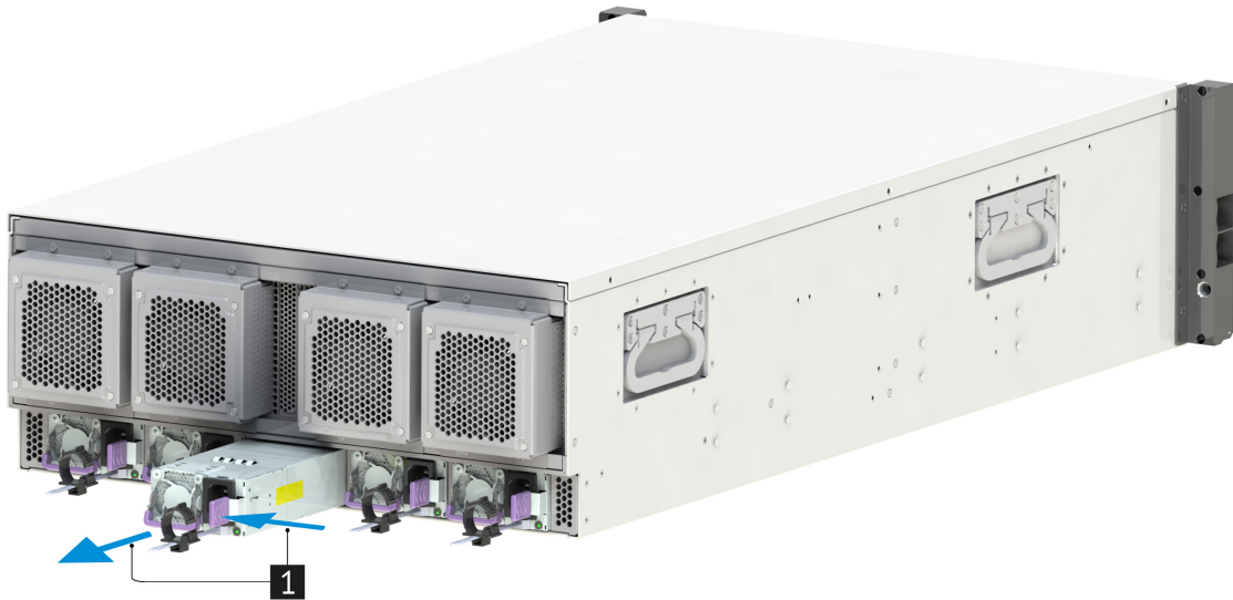
Рис. 49. Извлечение блока питания из сервера
